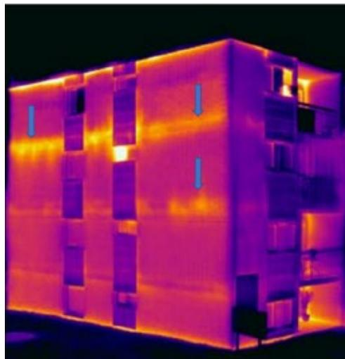
L'analyse d'un thermogramme est complexe. L'interprétation des données exige en effet la prise en compte de plusieurs facteurs. Pour bien saisir ce que les thermogrammes ont à dire, on doit, entre autres, tenir compte des caractéristiques de rayonnement et d'émissivité des matériaux. Par exemple, l'aluminium et la brique ne captent pas et ne diffusent pas la chaleur de la même façon.
