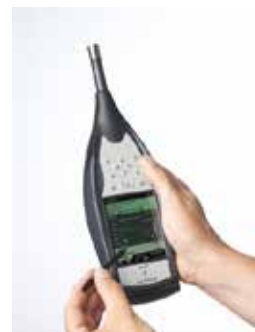
Figure 6. Sonomètre de marque Brüel et Kjaer.
